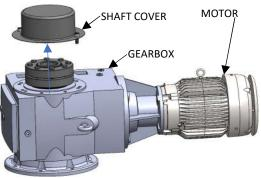
2.) DEBURR & CLEAN SHAFT AND HOLLOW BORE ID WITH ACETONE OR A SIMILAR SOLVENT. INSERT THE SHAFT INTO THE GEARBOX'S HOLLOW
