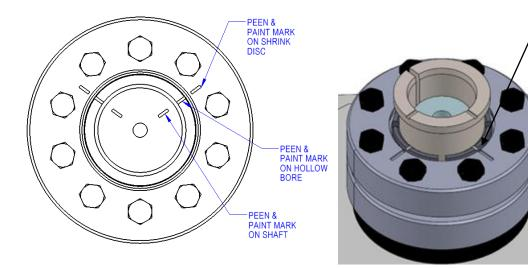
PEEN & PAINT MARK ON HOLLOW BORE
