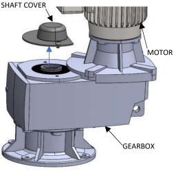
2.) ENSURE THE SNAP RING IS IN THE GEARBOX'S HOLLOW BORE.
