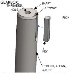
4.) INSERT THE SHAFT AND KEY INTO THE GEARBOX'S HOLLOW BORE. ENSURE THAT THE KEY IN THE SHAFT IS ALIGNED WITH THE KEYWAY IN THE GEARBOX'S HOLLOW BORE. THE SHAFT NEEDS TO BE IN CONTACT WITH THE SNAP RING.
