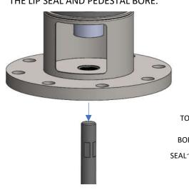
D.) PRESS THE SEAL IN BY USING A TOOL LIKE THE ONE SHOWN BELOW AND A DEAD BLOW HAMMER. MAKE SURE THE SEAL IS GOING INTO THE BORE SQUARE. NOTE THE ORIENTATION SHOWN BELOW, THE LIP SHOULD CURVE UP.
