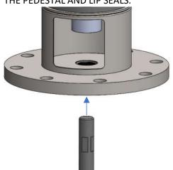
2.) ATTACH THE SHAFT TO THE MIXER DRIVE FOLLOWING THE APPROPRIATE SHAFT INSTALLATION QSG. THEN INSTALL THE IMPELLER FOLLOWING THE IMPELLER INSTALLATION QSG.
