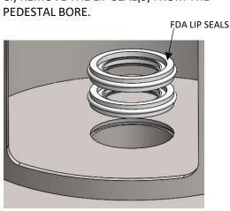
D.) PRESS THE NEW LIP SEAL(S) INTO THE PEDESTAL BORE. NOTE THE ORIENTATION SHOWN BELOW, THE LIP SHOULD CURVE UP.
