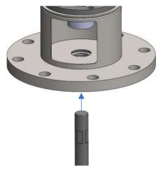
2.) ATTACH THE SHAFT TO THE MIXER DRIVE FOLLOWING THE APPROPRIATE SHAFT INSTALLATION QSG. THEN **INSTALL THE IMPELLER FOLLOWING** THE IMPELLER INSTALLATION QSG.
