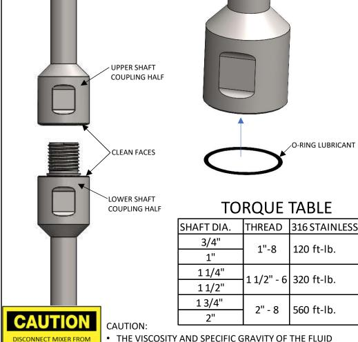
THE VISCOSITY AND SPECIFIC GRAVITY OF THE FLUID AFFECTS MIXER SIZING AND SPECIFICATIONS DO NOT LAY MIXER ON THE SHAFT
